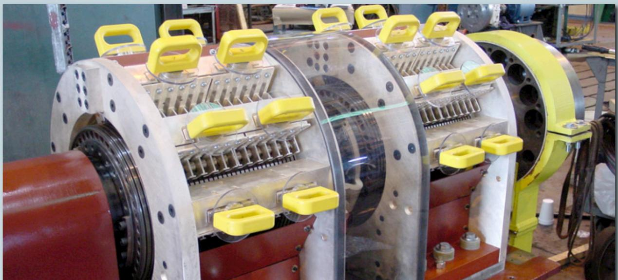
Excitatriz montada sobre el eje del rotor
